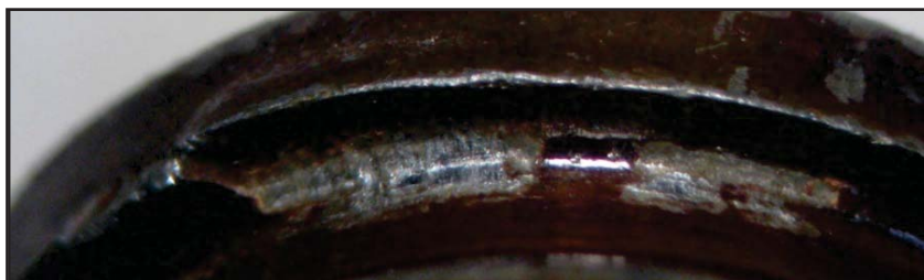
Рис. 8. Слід викидача, утворений на денці однієї з гільз, стріляних у режимі автоматичного вогню
