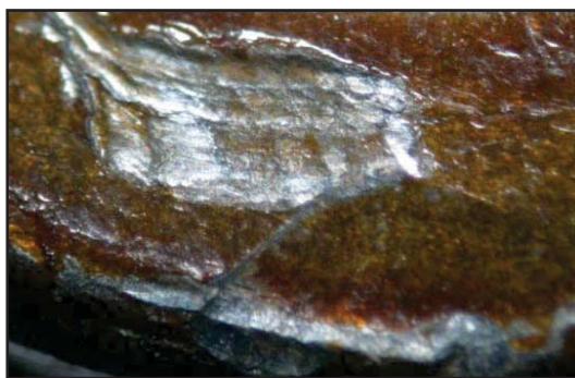
Рис. 6. Траси, що відобразилися ліворуч від вищевказаного сліду відбивача, утворені на денці однієї з гільз, стріляних у режимі автоматичного вогню
