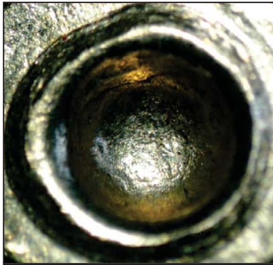
Рис. 1. Слід бойка, утворений на капсулі однієї з гільз, стріляних у режимі одиночного вогню
