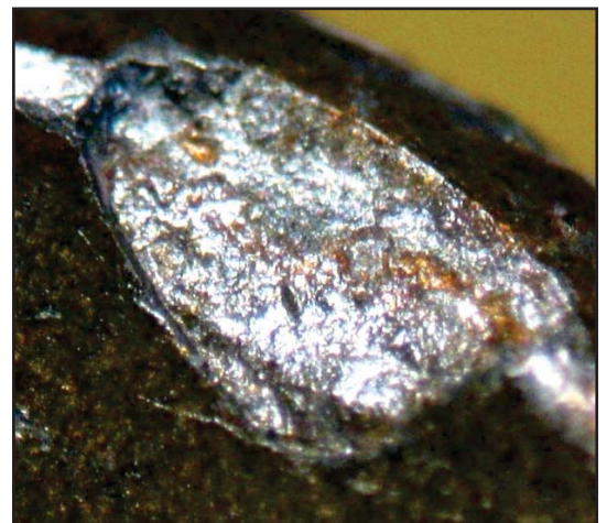
Рис. 4. Слід відбивача, утворений на денці однієї з гільз, стріляних у режимі автоматичного вогню
