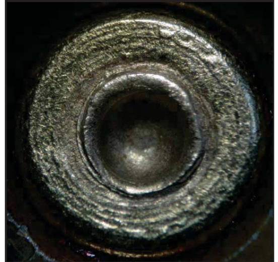
Рис. 10. Слід патронного утику, утворений на капсулі однієї з гільз, стріляних у режимі автоматичного вогню
