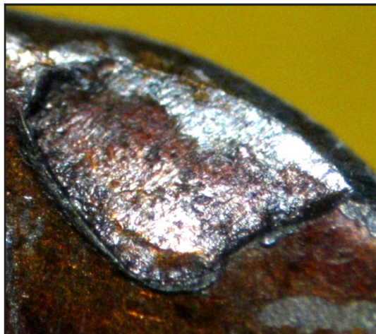
Рис. 3. Слід відбивача, утворений на денці однієї з гільз, стріляних у режимі одиночного вогню
