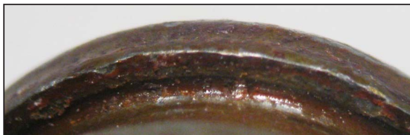
Рис. 7. Слід викидача, утворений на денці однієї з гільз, стріляних у режимі одиночного вогню
